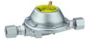
13 VORDRUCKREGLER TYP DE 50/30 S 0,8 kg/h, 30 mbar, bds. RVS8. Zur sicheren und normgerechten Integration von 30 mbar Gasgeräten in 50 mbar Flüssig-gasanlagen in Fahrzeugen und Booten. 9955457 73,50
