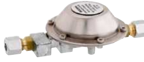
12 NIEDERDRUCKREGLER G76 (1,5 kg/h) Zum Anschluss von 30 mbar Caravans bzw. Motorcaravans (Reisemobile) an 50 mbar Standleitungen. Nur zur Verwendung im Freien geeignet! Nicht innerhalb von Fahrzeugen verwenden! Anschluss RVS 8 x RVS 8. 9952384 52,75
