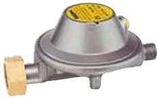
10 „CARAMATIC BASICONE EN71 1,2KG/H 30MBAR SHELL- F X G1/4LH-KN PRV CH“ Zum Anschluss an Gasflaschen und zur Druckregelung auf den Nenndruck des Gasgerätes. Mit integrierter Sicherheitseinrichtung gegen Überdruck. 9926764 37,25
