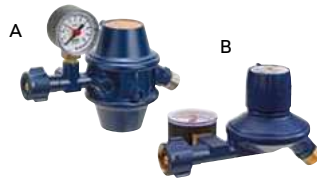
16 ZWEIFLASCHENANLAGE CARAMATIC BASICTWO Zweiflaschenanlage Caramatic BasicTwo Regler-Umschalt-automatik, zum Anschluss an Gasflaschen, zur Druckregelung auf den Nenndruck des Gasgerätes. Bestehend aus: Zentral- (A) und Umschaltregler (B) mit Manometer, Schlauchleitungen und MiniTool. Anschluss 30 mbar. Gasverbrauch 1,5 kg/h. 9970395 196,50 Anschluss 50 mbar. Gasverbrauch 1,5 kg/h. 9970396 196,50 Passt zu 9970397 Basic Control S 256
